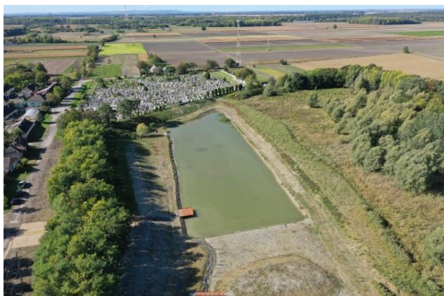
Obr. 17. – Realizovaná investícia: viacnádžové jazero – zrážková nádrž s otvorenou vodnou plochou. (Foto: Filmever Stúdió)
