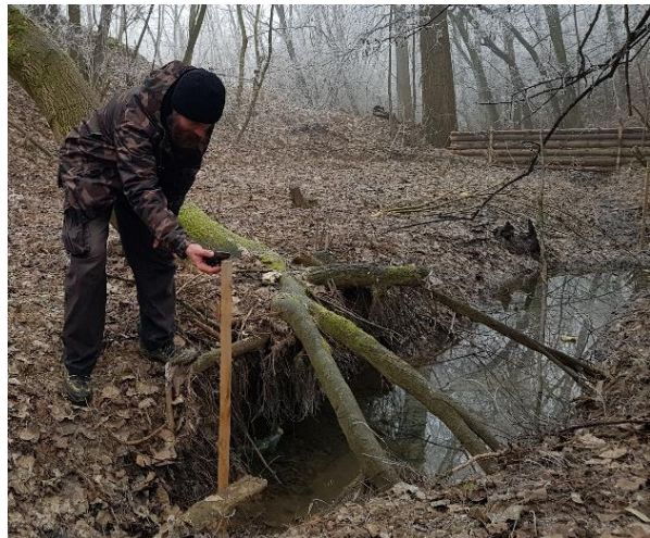
Obr. 48. - Vytvorenie jednoduchého meracieho systému na sledovanie zabahňovania úložiska za kmeňovými hrádzami v eróznom jarku. (Foto: WWF HU)
