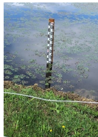
Obr. 42. - Inštalovaný vodočet v Tiszatarjáne. (Foto: samospráva obce Tiszatarján)
